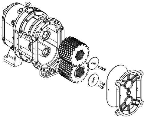
Per rendere più pratico e veloce il controllo e la sostituzione dei dischi dentati, l'accesso alla camera di lavoro avviene frontalmente senza interessare tenute e trasmissioni. - *For a practical and quick maintenance, the disks shredders can be checked and replaced directly from the front of the pump by removing the front flange, without interfering with the seals or the transmission.*
