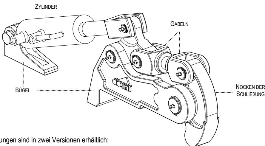
Die hydraulischen Schließvorrichtungen sind in zwei Versionen erhältlich:
