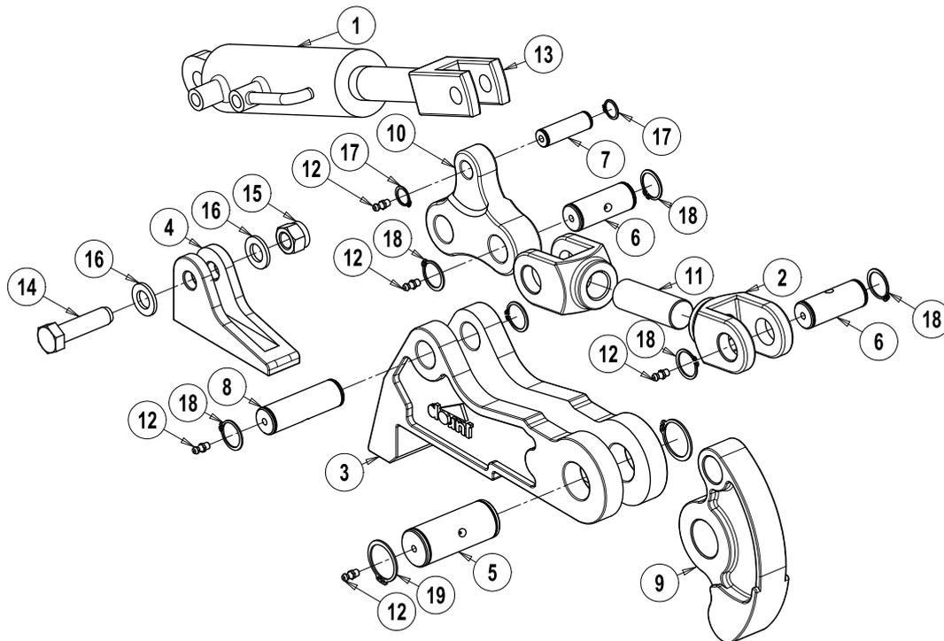
**Hydraulische Schließvorrichtung FE – Code 18300 008 10**
