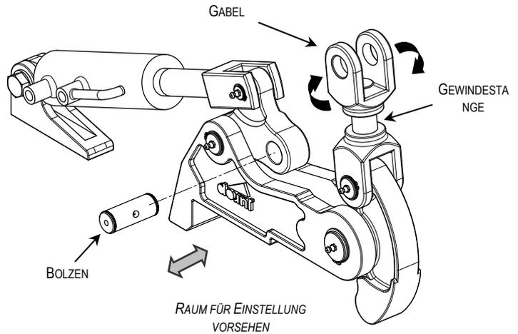
Um die Einstellung der Schließvorrichtungen zu erleichtern, sollte während der Installation der notwendige Raum für die Entfernung des Bolzens einer der beiden Gabeln vorgesehen werden.
